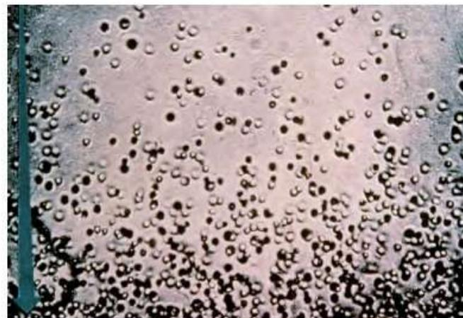
Microphotographie de la répartition en hauteur de sphères de résines en suspension dans l'eau.
