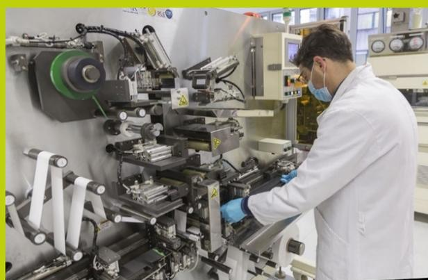
Assemblage batteries 18650 :
